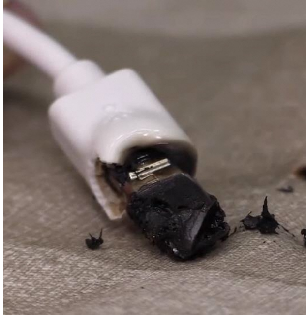
図5 焼損した充電ケーブルのコンネクタのイメージ（提供：NITE）
