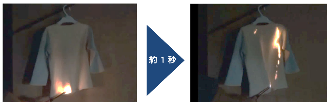
図5 表面フラッシュにより服の表面を火が燃え広がる様子
