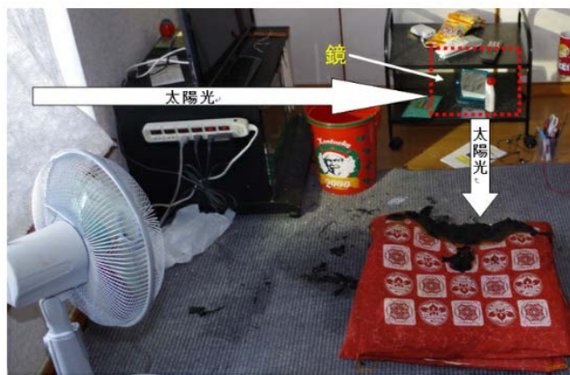
写真 カーテンの隙間から入ってきた太陽光を鏡が反射させて火災に 6
