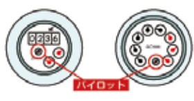
▲水道メーター内のパイロット
