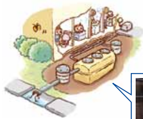
▲地下にある浄化槽のイメージ
