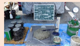
■ コンクリート受入試験結果の様子 中央の生コンがスランプ試験となります。
