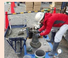
■ スランプコーン引抜きの様子
