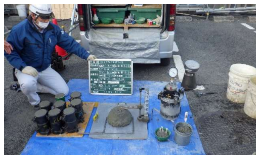
③コンクリート受入試験
